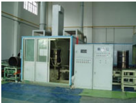
Покрасочное оборудование (Внутренняя окраска )
